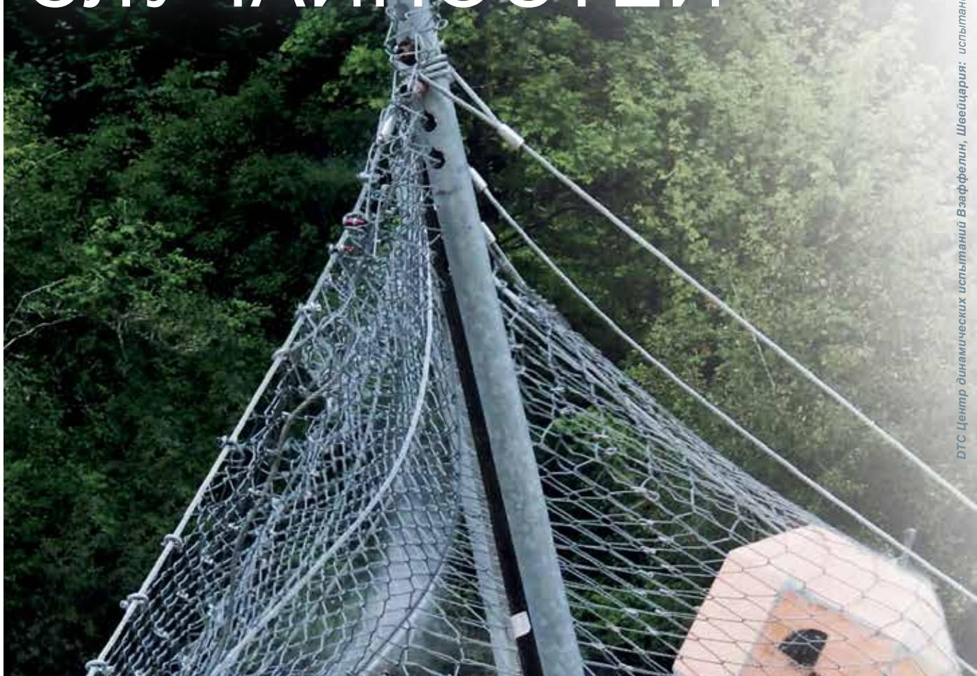
DTC Центр динамических испытаний Вэаффетти, Швейцария: испытания SPIDER® Avalanche 1:1
