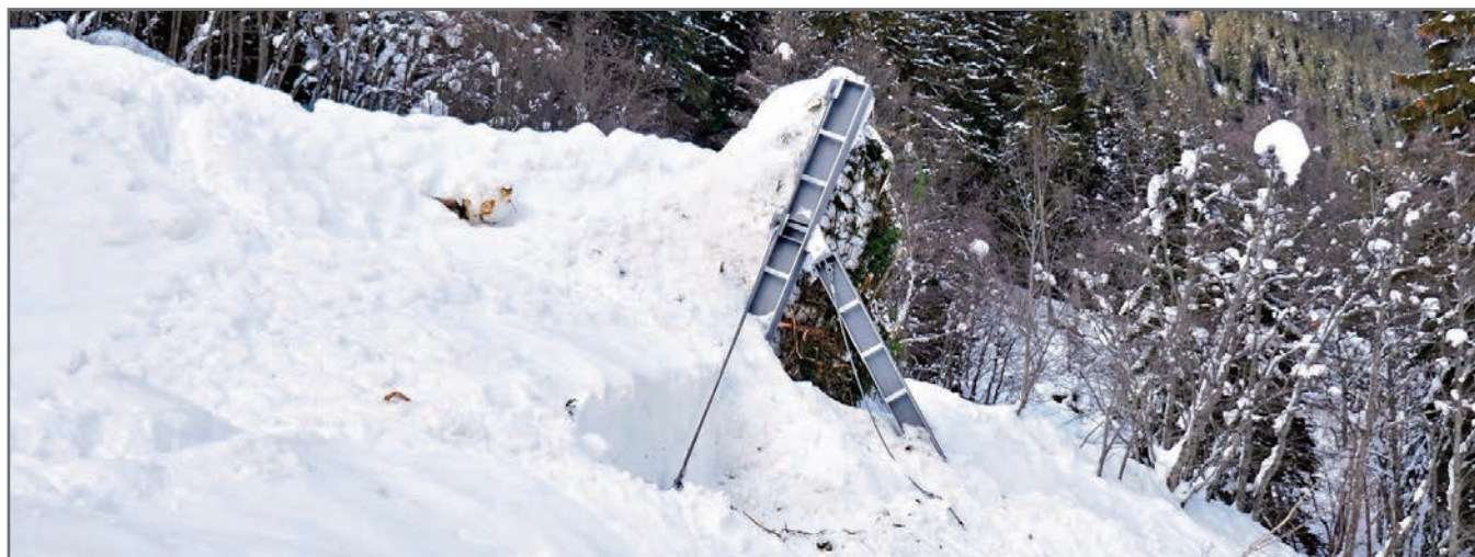
Рис. 8. Сработавший при испытании противолавинный барьер в зоне транзита лавины
