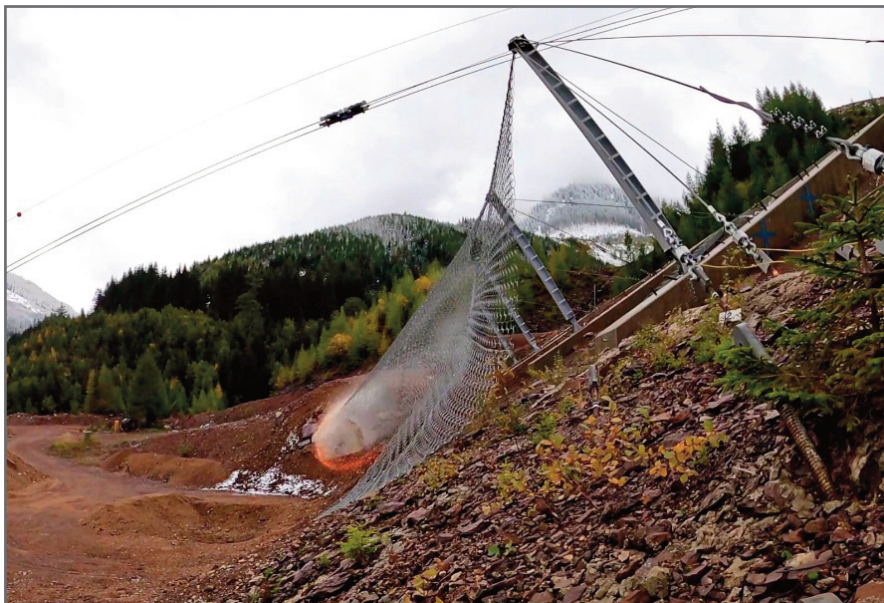
Рис. 3. Испытание аттенуаторного (ослабляющего) сетчатого барьера
