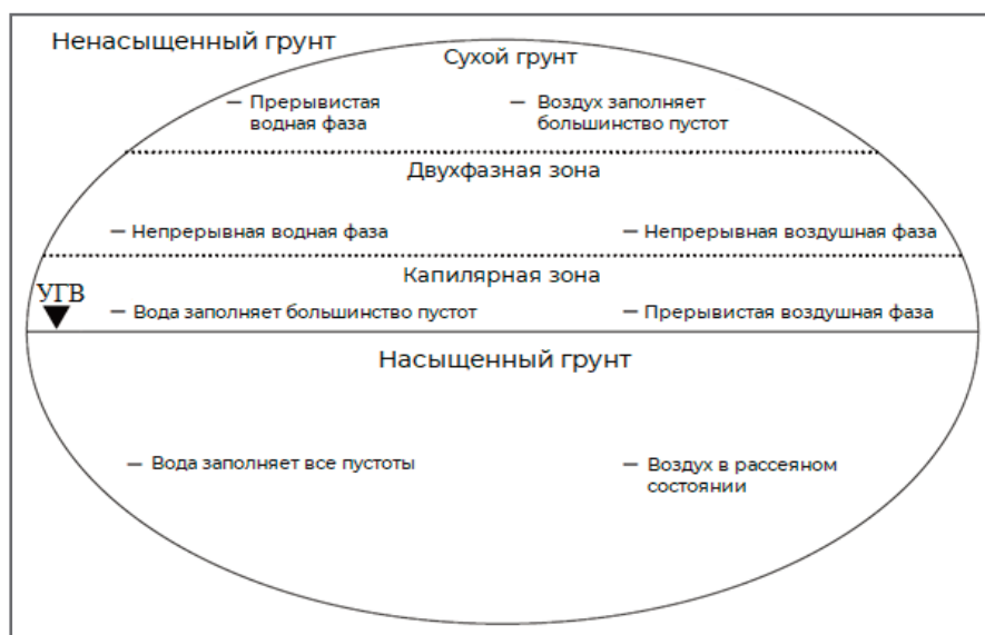
Рис. 2. Разделение толщи грунта на зоны по характеру присутствия газообразной и жидкой фаз
