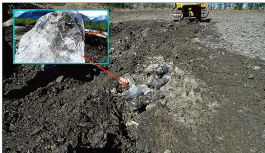
Рис. 4. Повторно-жильный лёд в борту карьера в водно-ледниковых отложениях высокой древней, боковой морены, 2016 г. Фото С.И. Серикова
