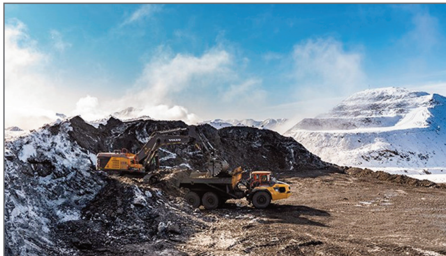
Рис. 6. Вскрыша рудного тела на месторождения Нежданнинское [7]
