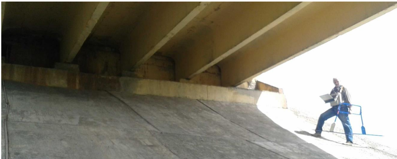
Рис. 4. Герардиолокационное обследование опор моста на автодороге Р-239 (промежуточной – а и концевой – б)
