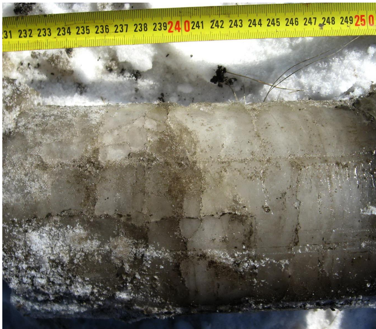
Рис. 2. Образец линзы инъекционного льда. КERN скважины №22 на интервале бурения 7,3-7,5 м
