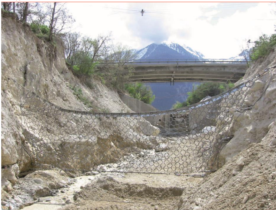
Рис.1 . Селевой стационар WSL на р. Иллграбене. В верхней части снимка – лазерный измеритель уровня. На несущие канаты барьера установлены тензометры
