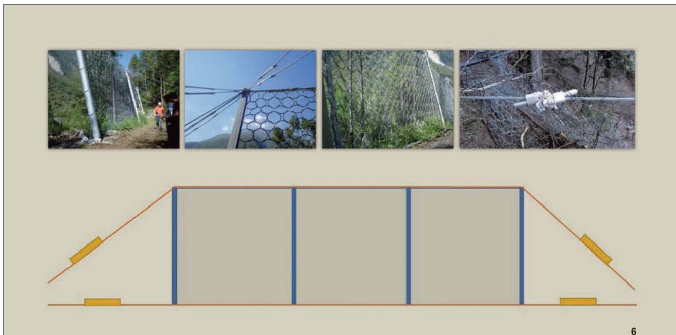
Рис. 3. Схема комплектующих камнеулавливающего барьера, соответствующего требованиям ETAG 027 (EAD 340059-00-0106)
