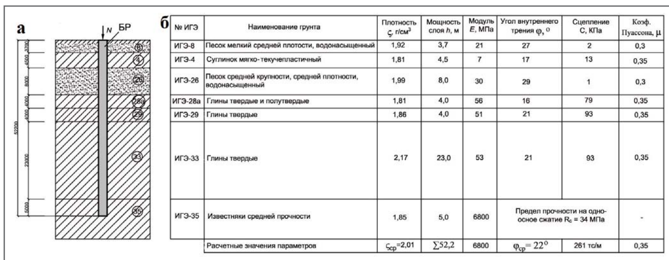
Рис. 1. Инженерно-геологические элементы (ИГЭ) и физико-механические параметры грунтов основания баретты (БР). N – нагрузка. Предел одноосного сжатия известняка R = 23 \text{ МПа} и модуль деформации E = 6800 \text{ МПа} приведены авторами по данным из статьи [7], однако возможно, что указанное значение E было представлено в работе [7] ошибочно, поскольку фактически известняк как разновидность грунта имеет значение E порядка 68 МПа
