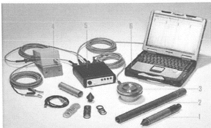
Рис. 5. Принципиальная схема акустического зондирования и комплект бескабельного оборудования компании «GEOTECH AB». 1 – наконечник зонда; 2 – акустический трансмиттер; 3 – микрофон; 4 – измеритель глубины зондирования; 5 – накопитель преобразователь данных (интерфейс); 6 – компьютер (полевой логгер)
