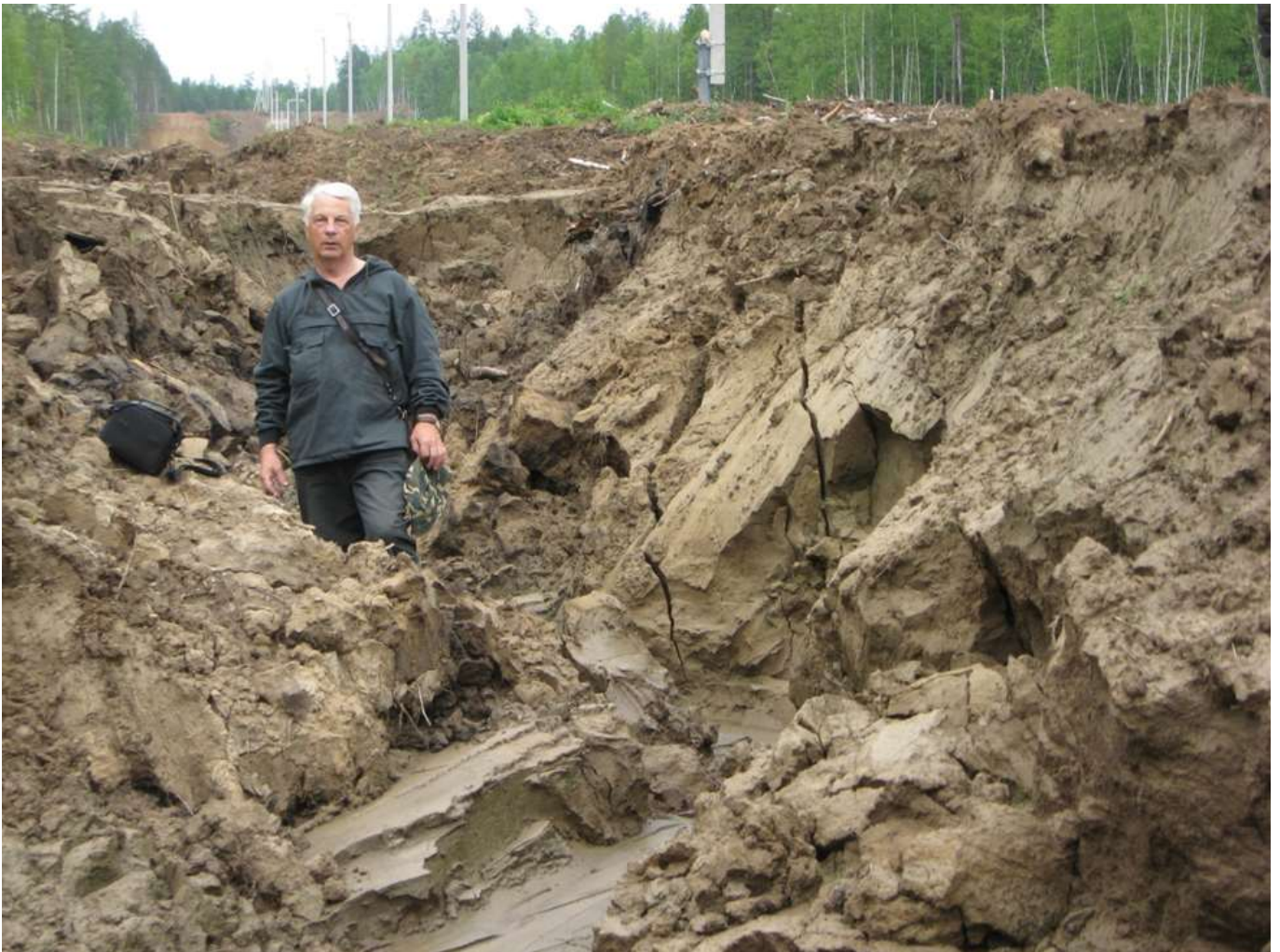
Рис. 4. Активная термоэрозия в средней части трассы. Фото И.В.Дорофеева
