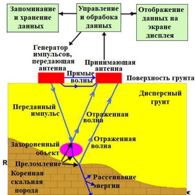
Рис. 1. Упрощенная схема работы георадара (по [2])
