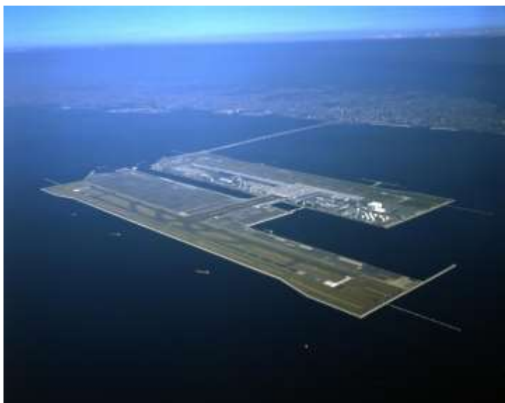
Рис. 1. Международный аэропорт Кансай, построенный в 1987–1994 годах на насыпном острове длиной 4 км и высотой 15 м над уровнем моря (30 м от дна) в Осацком заливе. Остров соединен 3-километровым двухэтажным мостом с городком Ринку – пригородом города Осака [2, 7]
