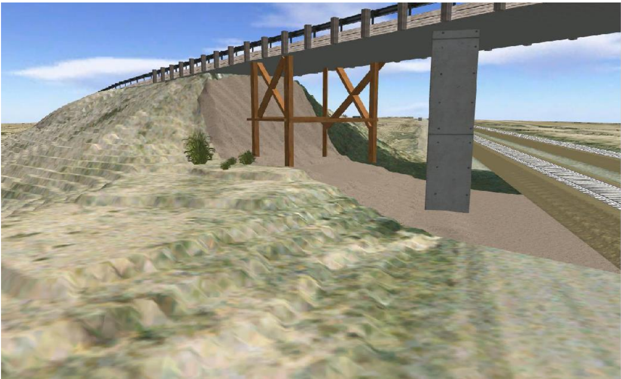
Рис. 5. Одно из проектных предложений по мосту Камбре, разработанное стажером Мэттью Оукли (Matthew Oakeley) в программе Autodesk InfraWorks всего за несколько часов. Фотография любезно предоставлена Департаментом транспорта штата Нью-Мексико США
