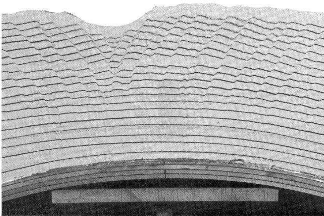
Рис. 2. Гребневидные сдвиги над аркой равномерной кривизны, смоделированные Мандлом (Mandl, 1984) в коробке, заполненной слоями плотного песка
