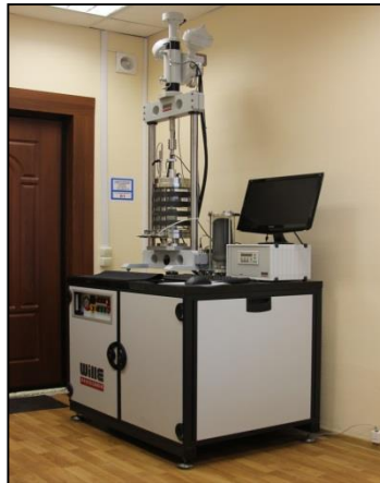
Рис. 2. Сервогидравлическая стабилометрическая установка Wille GeoTechnik 13-HG/020:001(Германия)
