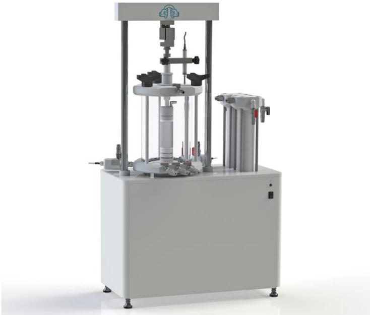
Новая статья из цикла о возможностях современного испытательного оборудования посвящена определению коэффициента относительного поперечного расширения. Долгое время данный параметр в рамках стандартной производственной лаборатории определить было практически невозможно, и в результате он до сих пор воспринимается как «справочный». Но современное оборудование делает эту задачу вполне разрешимой без дополнительных затрат.
