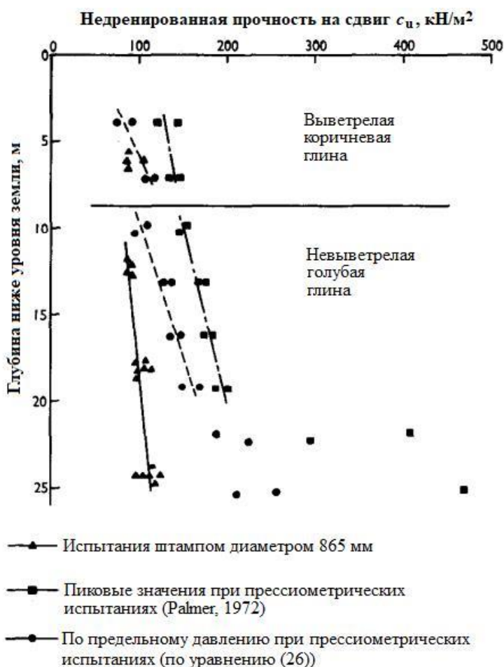
Рис. 10. Сопоставление значений недренированной прочности на сдвиг, определенных по результатам испытаний плоским штампом большого диаметра и pressiометром [2]
